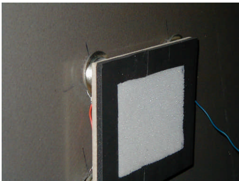
Abb. 4 : Die gekoppelten Exciter (Antrieb) des NXT-Lautsprecherpanels
