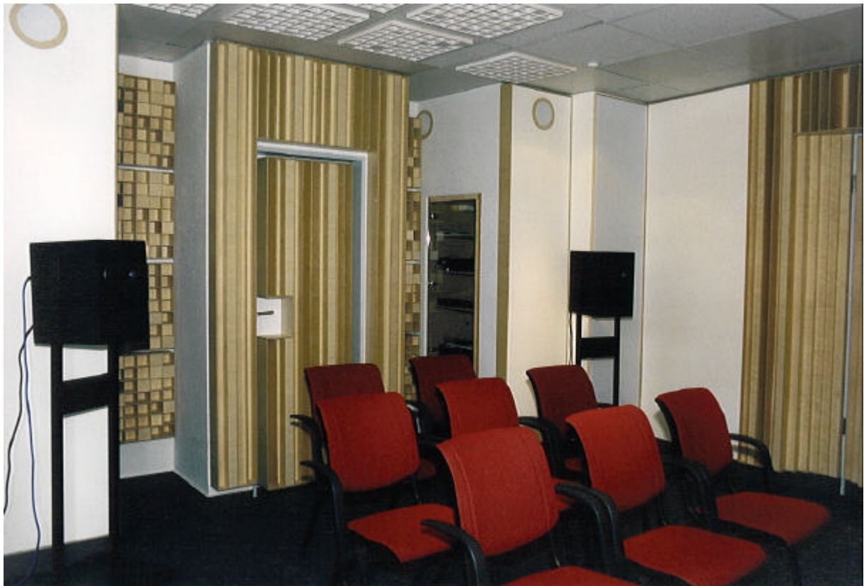
Abbildung 6: Rückwandansicht mit den hinteren Kanälen und der tieffrequenten Diffusorprofilierung der Rückwand
